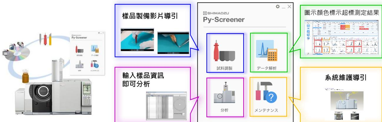
Py-Screener一開機，就會顯示分析磷苯二甲酸酯類時必須的4個圖示，使用者只需針對執行功能按下圖示。相較於功能設定較複雜的一般GCMS，有了PY-screener軟體，任誰都可輕易上手。
