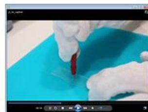
法規中磷苯二甲酸酯類的管制限值是0.1%(1000 mg/kg)以下，在IEC62321 Part 8的定量篩選中①Blank Check、②裝置的感度Check(100 mg/kg)、③製作檢量線的準備(1000 mg/kg)是必須的。備齊這些必須的樣品及工具，操作只需要遵循Video或手冊執行即可。由於不需要使用溶劑，可將操作產生的汙染控制到最低。
